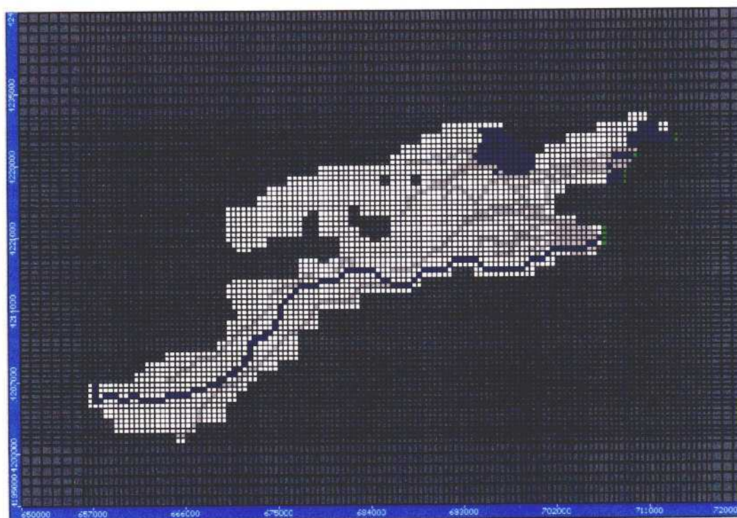
Figura 3.4 - Condiciones de contorno definidas en el modelo numérico de la Vega del Segura (Capa 1) (Caudal nulo = verde oscuro; Dren = gris; Goteo o mixta= azul y GHB = verde claro)
